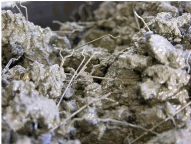
Gambar 6.1. Campuran Beton dengan Serat Baja
