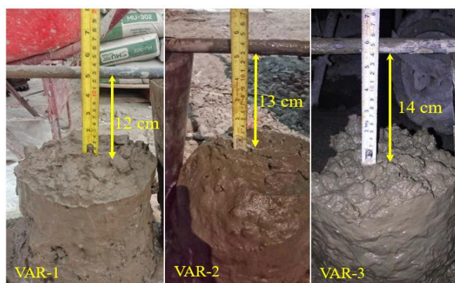
Gambar 4 Hasil uji slump masing-masing variasi campuran
