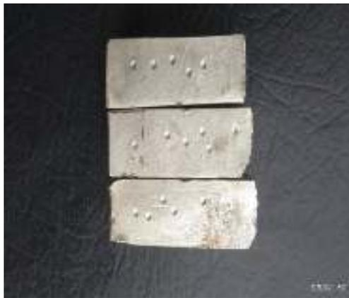
Gambar 12. Spesiemen Hasil Pengujian Kekerasan
