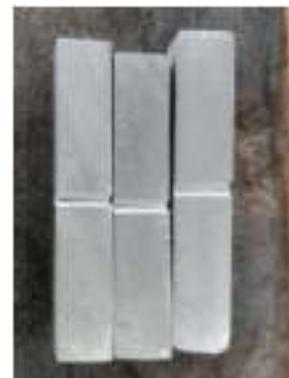
Gambar 6 Spesimen Uji Impact
