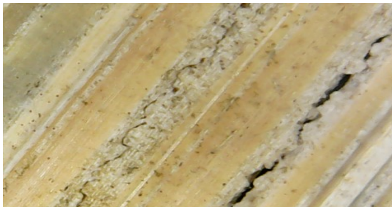
Gambar 4.5a Foto Mikro Sampel Setelah Direndam 2 Minggu
