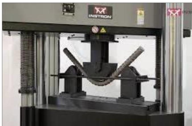
Gambar 3.5. Pengujian Tekuk Logam
