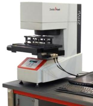
Gambar 3.16. Alat Uji Metode Vickers
