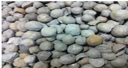
Gambar 1.1. Logam Sponge Hasil Proses *Sintering*
