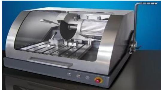
Gambar 3.20. Mesin Potong Spesimen Logam
