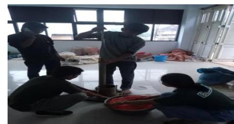
Gambar 5. Pembuatan Benda Uji CBR.
