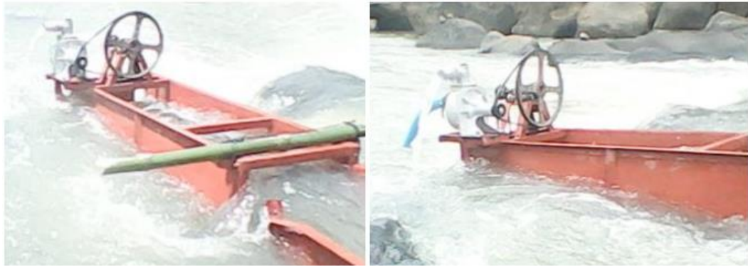
Gambar 3. kincir air sebagai tenaga penggerak pompa
