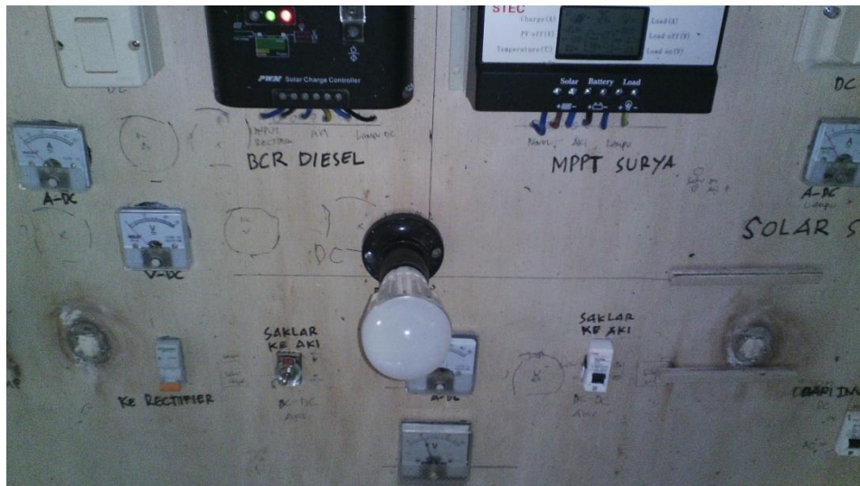
Gambar 5. Prototipe pengujian system hibrid PLTS dengan Genset
