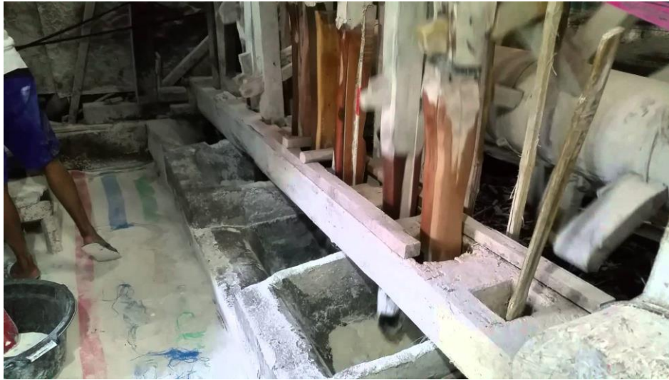
Gambar 5. Kincir air digunakan sebagai penumbuk padi ( Ibrahim dkk., 2014)
